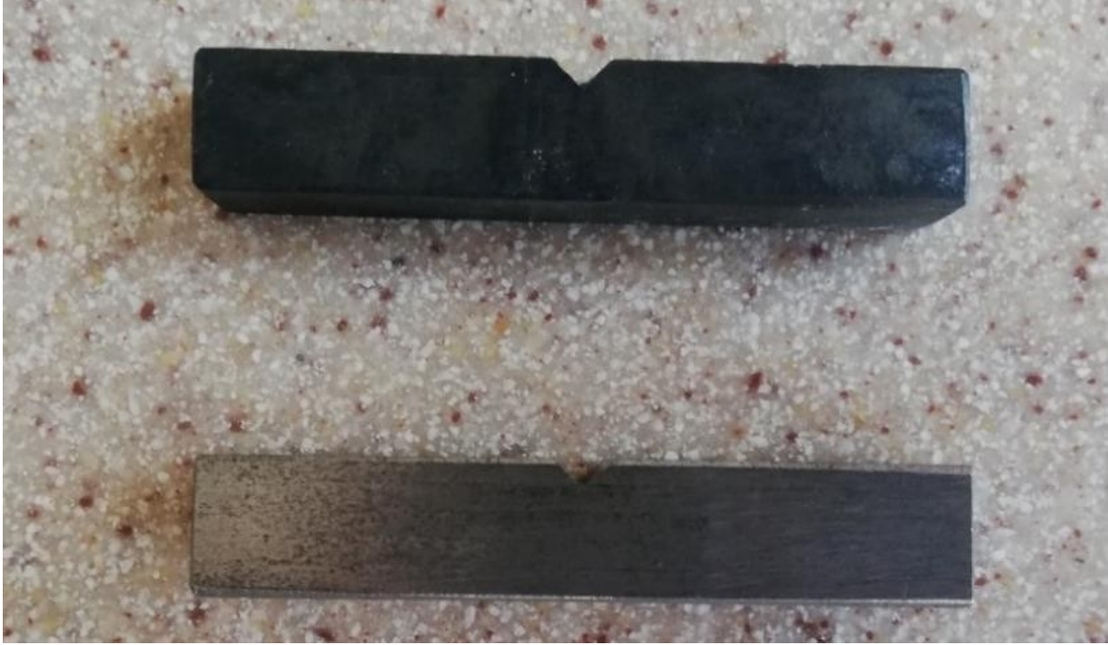
Resim 1 Isıl işlem uygulanmış ve uygulanmamış darbe deneyi numuneleri.
